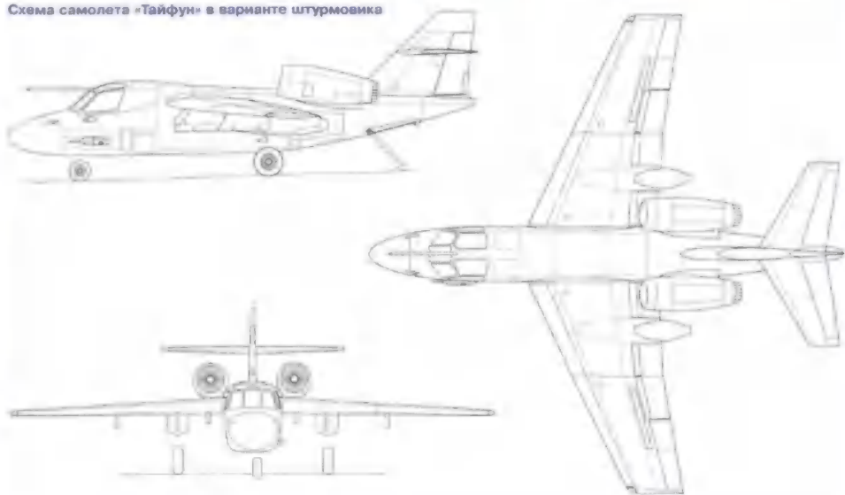
Схема самолета «Тайфун» в варианте штурмовика
